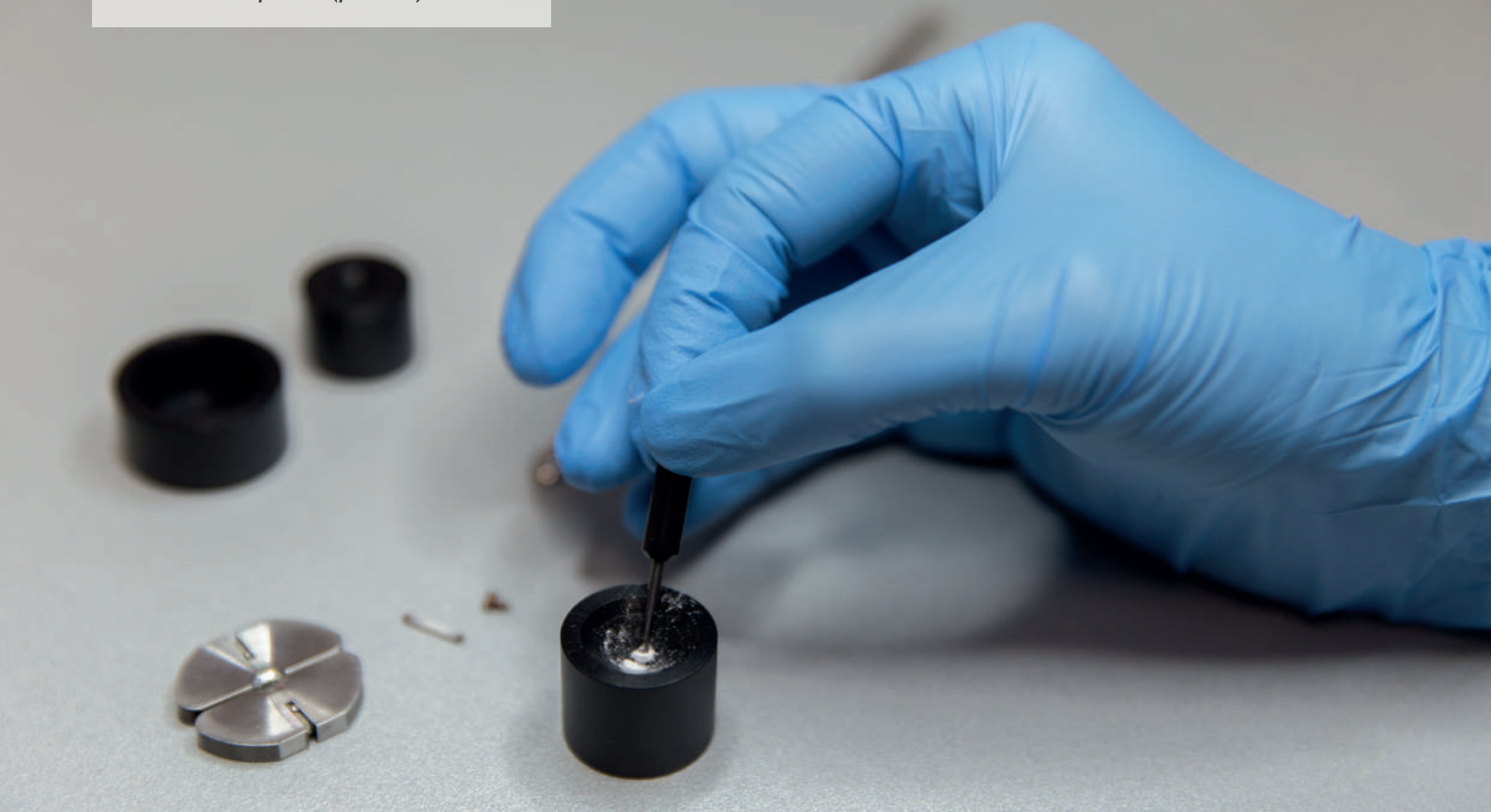
Introducerea probei (pulbere) în rotor
