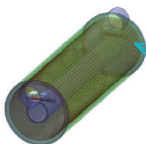
Reactoare fotocatalitice cu configurație axială și sistem de iluminare UV
