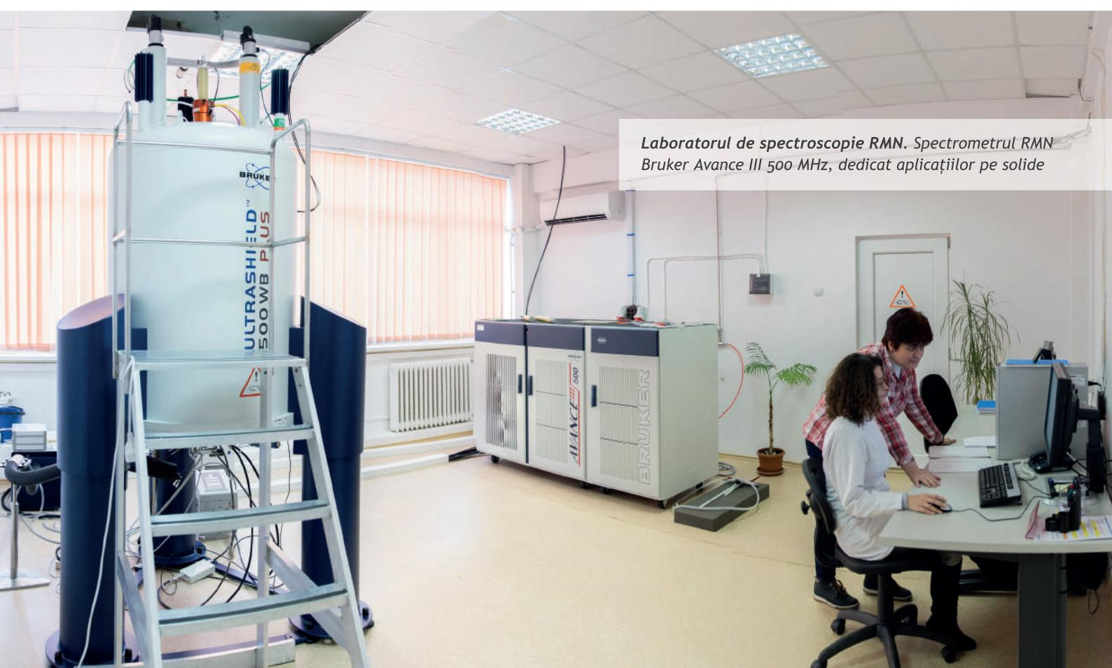
*Laboratorul de spectroscopie RMN. Spectrometrul RMN Bruker Avance III 500 MHz, dedicat aplicațiilor pe solide*
